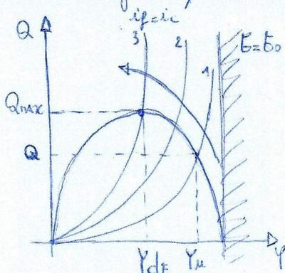
Dal grafico si evince che tutto dipende dalla pendenza. Nel caso di  $Y_u > Y_c$  (alveo fluviale) la pendenza avrà un certo valore  $ip < ic$  e determinerà una portata  $Q$ . Man mano che  $ip$  cresce  $Q$  aumenta e  $Y$  diminuisce.  $Q$  sarà massima per  $ip = ic$ . Se  $ip$  cresce ancora la configurazione diviene verso quella torrentizia (e  $Q$  rimane  $Q_{max}$ ).
